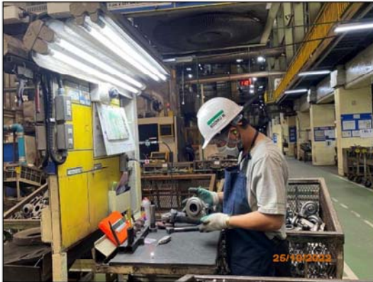
ภาพที่ 2.2-37 คอมไฟและหลอดไฟฟลูออเรสเซนต์เฉพาะจุด
